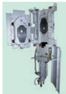
当社が開発したスライドゲートプレートを開閉する装置。コンパクトで操作性が良く、多くのお客様からご好評いただいている
