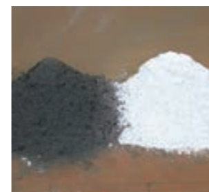
モールドパウダーの外観。モールド内の溶鋼表面における広がりや溶解性状を個別に最適化した結果、白色を呈するものや黒色を呈するものがラインナップされている
