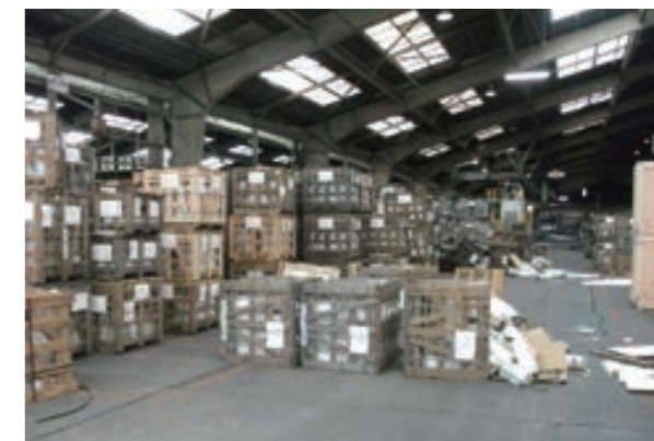
工場の製品置場：地震で転倒
