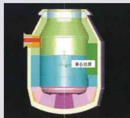
転炉 3D CAD による重心位置算出
